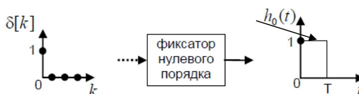
Рисунок 4.2 – Импульсная характеристика экстраполятора (фиксатора) нулевого порядка (амплитуда импульсной характеристики должна быть  $1/T$ )
